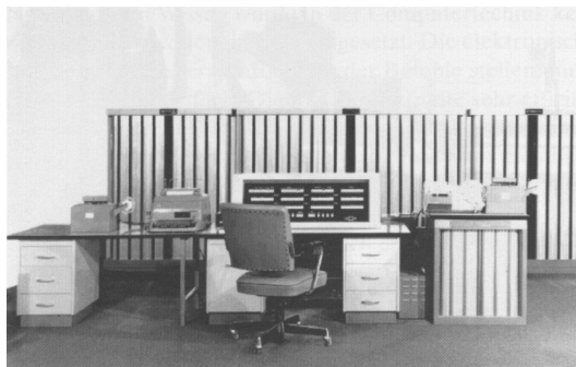
Abbildung 17: Die Rechenmaschine Z23 in Transistortechnik
